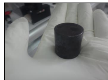
天然ウランペレット (直径約24mm、高さ約25mm、約115g)
