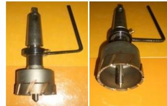
私の工作室では $\phi 14 \sim \phi 19$  (板厚35までの貫通穴)、 $\phi 20 \sim \phi 80$  (板厚50までの貫通穴) の場合は、ドリルであけると何段階もドリルの径を変えてあけるのは時間がかかり効率が悪いのでポンチを打った後に右の写真の道具を使って1度で穴をあけます。
