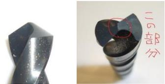
硬い金属ほどドリル径を変える回数を増やすとドリルの摩耗も軽減でき、穴をあける時にドリルを押し付ける力もいなくなり、効率もあがります。ただし、真鍮材に穴をあける場合は大きな径の穴でも1度であけます。1度小さな径の穴をあけてから大きな径の穴をあけようとするるとドリルの先端の抵抗がないために切り込み量が大きくなりドリルが真鍮材に食い込んでしまい危険になってしまいます。
