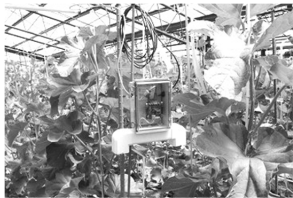
図1 ハウスに設置された圃場環境モニタリング装置
