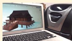
これは、3次元CGソフトウェアで作成した形状データや実物体から3Dスキャナで取得した形状データなどからその形状と同じ実モデルをABS樹脂などの材料で作成する装置です。考古学で発掘された貴重な有形資料のレプリカ作成や、都市工学で建物や橋梁の図面からサンプルモデルを作成するなどの活用が考えられます。297×210×200mm<sup>3</sup>の大きさまでのモデル作成が可能です。また、半透明の樹脂の場合、内部の構造を見ることができるモデルの作成も可能です。講義中に学生に閲覧させる目的でのモデル作成に限らず研究目的での利用も歓迎いたしますので、是非ご活用ください。
